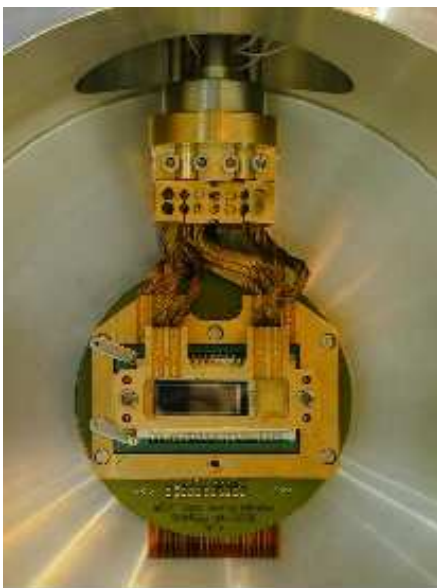
Abbildung 3.3: Dargestellt ist im unteren Bildbereich der rechteckige CCD-Chip (schwarzer zentraler Teil) umgeben von einer gelblichen Cu-Kühlmaske und einer Goldbeschichtung. Neben der Detektorelektronik ist die Verbindung des CCD-Chips mit dem Kühlfinger eines Stirling-Kühlers im oberen Bereich des Detektors zu sehen. Die Abschirmung durch die Kupferbox ist hier entfernt worden.
