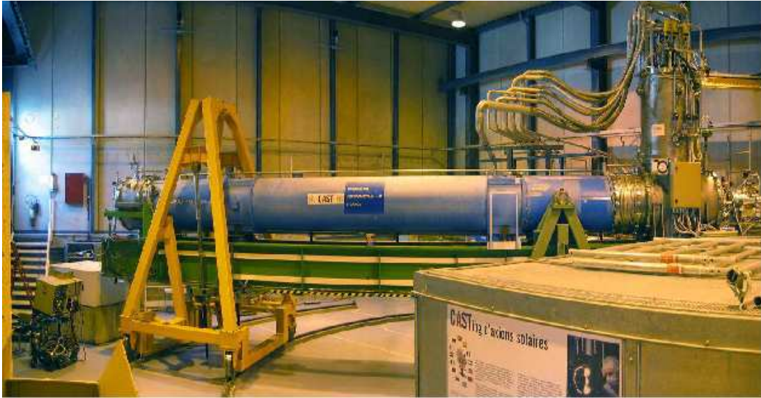
Abbildung 2.3: Der supraleitende Magnet von CAST in Ausrichtung auf die Sonne. Am linken Ende des Magneten ist die TPC normalerweise angebracht (hier im Bild nicht zu sehen), am rechten Ende (nicht zu sehen) befinden sich der pn-CCD-Detektor und die MICROMEAS-Kammer.
