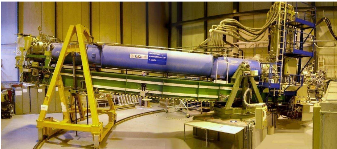
Abbildung 1.1: Bild des CAST Experiments. Links der Magnettröhre befindet sich die TPC, rechts der Micromegas Detektor sowie das Röntgenteleskop mit dem CCD Detektor (Quelle http://cast.web.cern.ch/CAST/CASTwebB/CAST.htm ).
